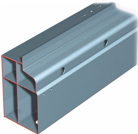
Schwellerprofil Audi TT Coupé '07 Vierkammer Strangpressprofil
